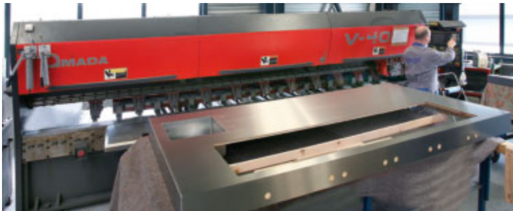
De Amada V-4012 wordt ingezet bij de Snep Exact-Fold-techniek die het mogelijk maakt plaatwerk profielen te maken die met conventionele technieken niet mogelijk zijn.
